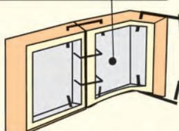
Кріплення (скобу) виготовляють з сталевого дроту діаметром 3-4 мм. Шви заповнюються розчином. Для приготування розчину готують суміш (50 % глини жовтої, білої і 50 % піску) та розбавлюють водою до утворення в'язкої однорідної маси. Вага розчину на 1 комплект до 120 кг.
